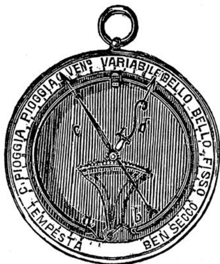
Fig. 9 / Barómetro aneroide o metálico. Entre estos barómetros el más vulgarmente en uso es aquel imaginado por Bourdon. Una lámina vacía curva una sesión elíptica está unida a sus dos puntos a , b , con una doble palanca, la cual
