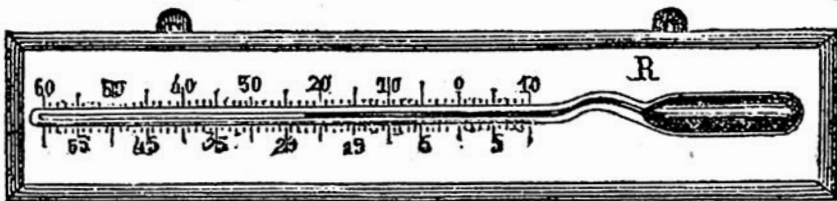
Fig. 37 / Termómetro de máxima Negretti.
