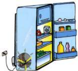
Heladera con fuga a tierra
